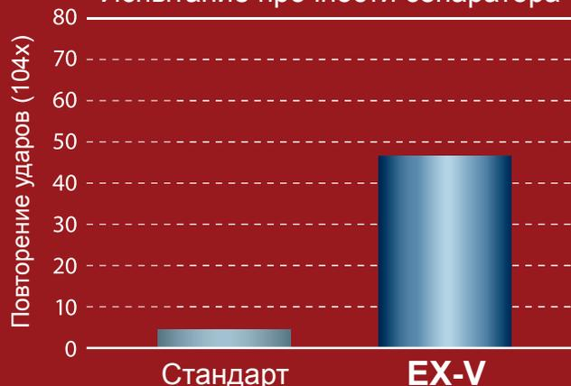
**Допускаемая ударная нагрузка на EX-V в 10 раз превышает нагрузку на стандартные сепараторы.**
