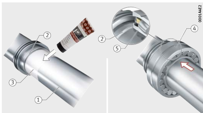
Рисунок 14 Нанести монтажную пасту, установить подшипник
