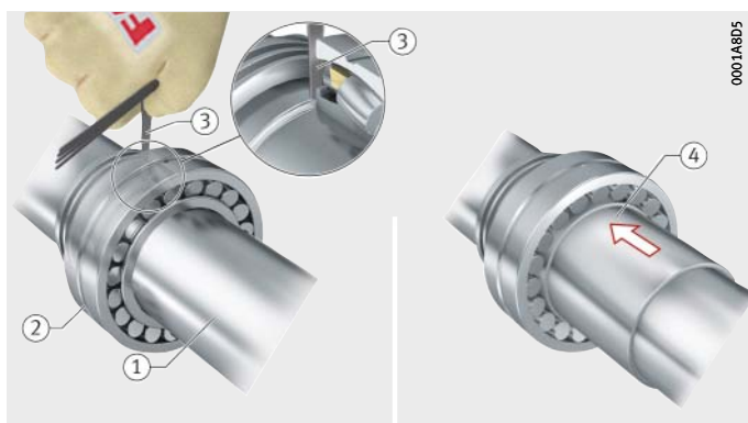
Рисунок 15 Проконтролировать прилегание внутреннего кольца подшипника к заплечику вала, установить дистанционную втулку (если вал проходит сквозь корпус)
